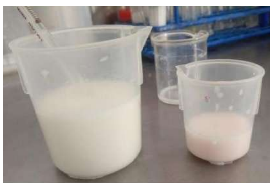
Figura 7: Prueba de titulación de acidez.
