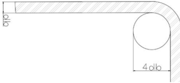
Figura 11. Doblado de varillas de patas y ganchos.
