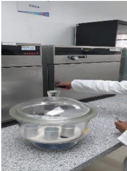
Preparacion de cazoz metalicos
