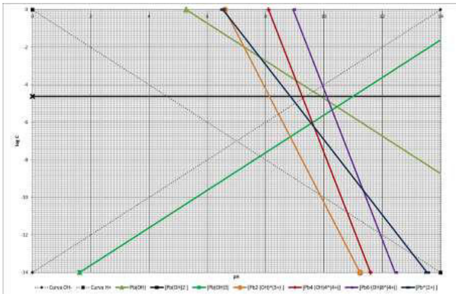
Figura 7. Diagrama logC- pH del sistema Pb_2 + H_2O a 298 °K.
