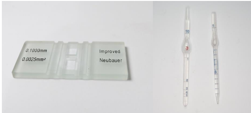
Figura 3. Cámara de Neubauer y pipetas de Thoma.
