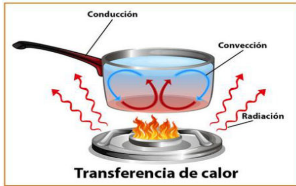
Figura 3.3. Mecanismos de transferencia de calor
