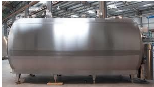
Figura 29: Depósito autorefrigerante cerrado.
