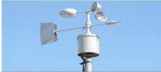
Figura 3.3. Anemómetro de cazoletas para velocidad de viento y veletas para medir su dirección.
