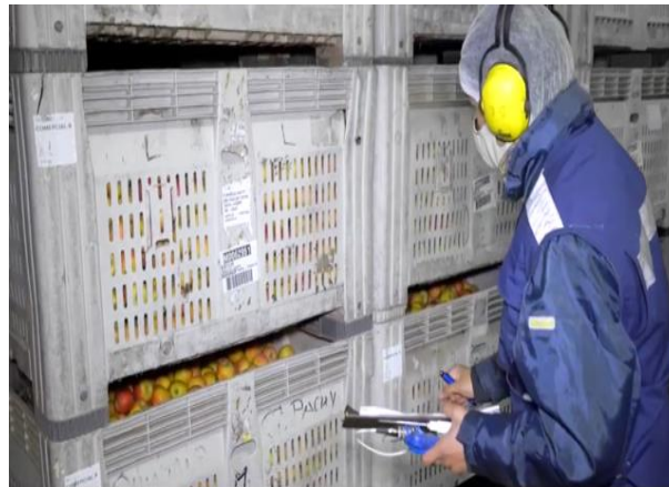
Ilustración 4. 121. Control de temperatura en cuartos fríos.
