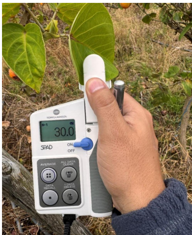
Figura 1.14. Medición en campo del índice relativo de clorofila mediante el equipo Konica
